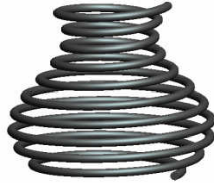
Hình 1.3 Loxo với đường sinh spline
