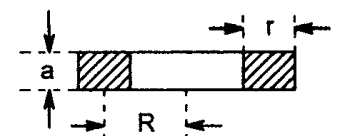
Hình 1.39. Các kích thước cơ bản của vòng dây
